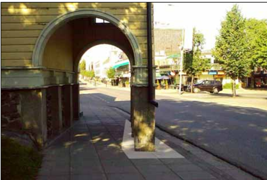
Kuva 76. Havainnekuva varoitusalueesta seinäkkeen pilarien ympärillä
