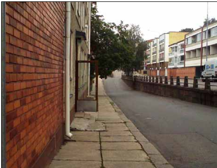
Kuva 49. Kulkuväylälle työntyvät kiinteistön portaat aiheuttavat törmäämisvaaran heikkonäköiselle tai sokealle henkilölle
